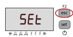
**Important : La température doit être réglée entre 1°C et 5°C par des techniciens spécialisés sur la base des instructions figurant dans le manuel d'entretien de ce produit.**
